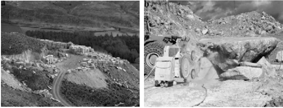
Fig. 2. a: Aspecto general de la cantera "Monteagudo". b: Sistema de corte en la cantera mediante hilo diamantado.
